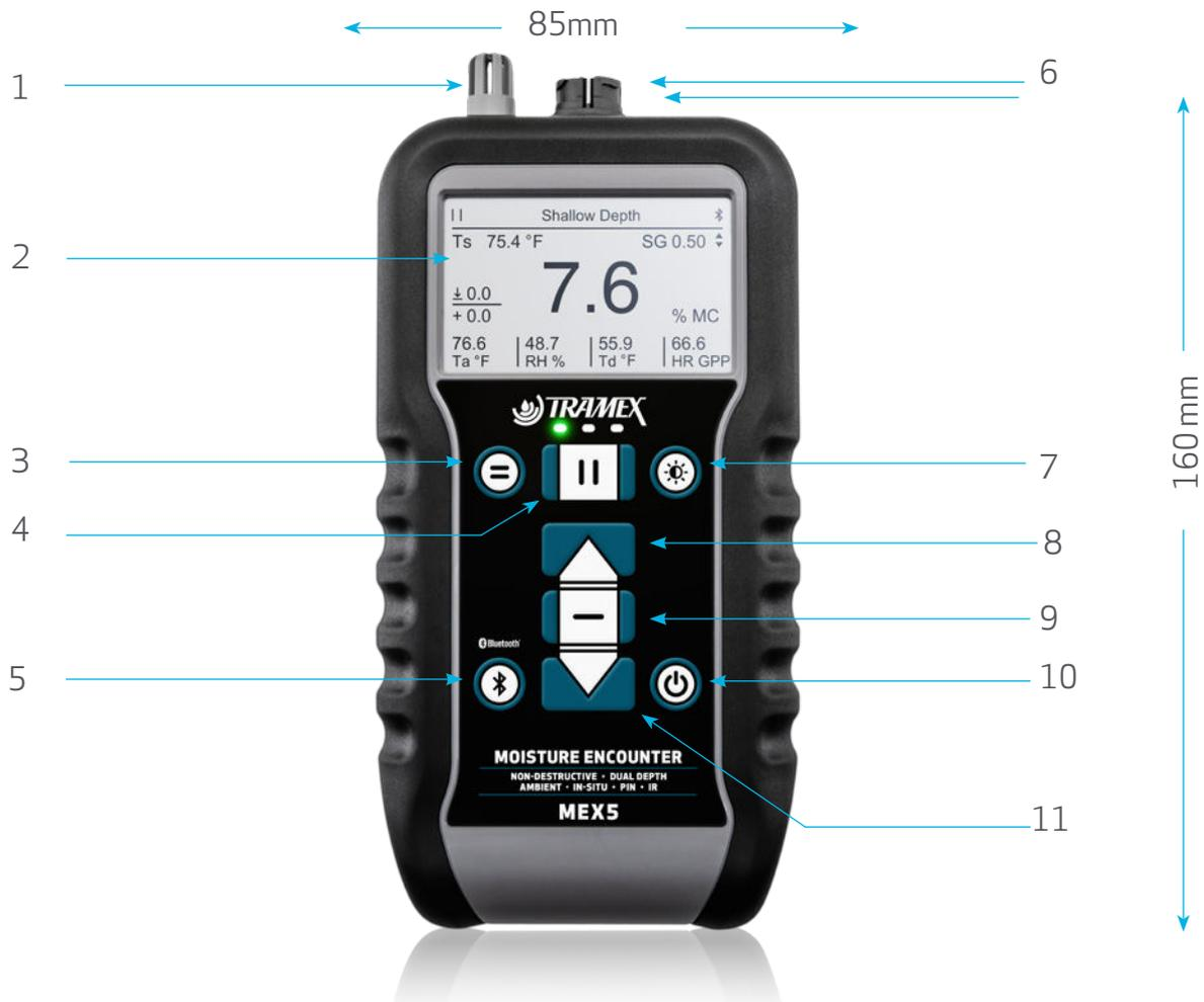
1. Sonde für Umgebungsluftfeuchtigkeit
