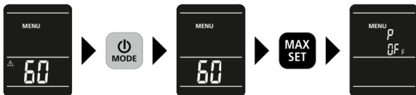
Das Gerät verfügt über eine automatische Abschaltung. Sie kann nach 3 Minuten oder 60 Minuten erfolgen. Für den Einsatz des Gerätes als Hygrometer zur Überwachung des Raumklimas ist die Einstellung der automatischen Abschaltung nach 60 Minuten sinnvoll.
