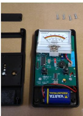
Die vier Schrauben den Klippdeckel sowie die beiden Gehäuseteile nebeneinander hinlegen. Das alte Display samt rot-schwarzem Kabel am weissen Stecker vorsichtig von der Platine lösen.
