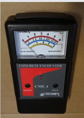
Den Klippdeckel schliesslich ganz einklicken. Gerät einschalten und Kontrollmessung an der Referenzfläche vornehmen. Die Werte der roten Skala muss beim alten und beim neuen Display identisch sein.
