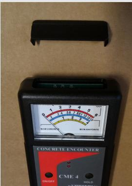
Gehäuseoberteil vorsichtig über das Display stülpen und am unteren Gehäuseteil ausrichten. Zuerst die Schrauben wieder montieren und anschliessend den Klippdeckel an der oberen Strinseite in der passenden Ausrichtung ansetzen und mit leichtem Druck an beiden Seite die erste Stufe einklicken.
