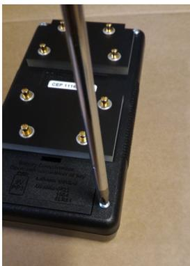
Rückseitig die vier Schrauben lösen und das obere vom unteren Gehäuseteil vorsichtig trennen. An der oberen Stirnseite des Gehäuses ist ein Klippdeckel, der sich nach dem Lösen der Schrauben abnehmen lässt.
