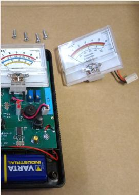
Neues Display in der gleichen Weise mit dem weissen Stecker auf der Platine anstecken und ausrichten.
