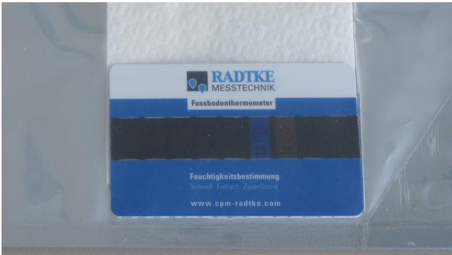
Feld grün entspricht die Zahl der aktuellen Temperatur resp. ist das Feld blau, wird zur abgebildeten Temperatur ein Grad dazugezählt. Im vorliegenden Bild ist das 26-er Feld braun, so dass wir eine Temperatur von rund 25°C vorliegen haben. Bei 25°C stellt sich im Innenraum des Kalibrierbeutels eine Gleichgewichtsfeuchte von 75.3%r.F. über der gesättigten Salzlösung ein.
